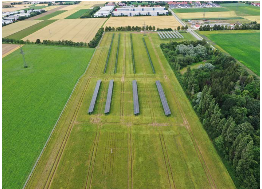
Bild 1: Die Agri-PV-Anlage in Poing-Grub besteht aus drei verschiedenen Agri-PV-Systemen: Hinten rechts die hoch aufgeständerte Anlage, in der Mitte hinten die vertikal angeordneten Module, vorne in der Mitte die nachgeführte Anlage und ganz vorne links die Referenzparzellen ohne Modulbeeinflussung (Fotos: TFZ)
