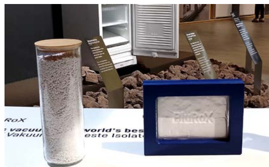
▣ Bild 2: Perlit – Rohstoff und Vakuumisolierung (enthält gemahlenen Perlit)
