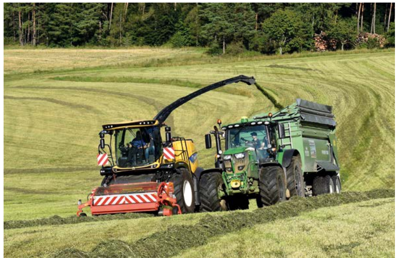
■ Bild 5: Selbstfahrender Feldhäcksler mit NIRS-Technik bei der Grünlandernte (Foto: LfL)
