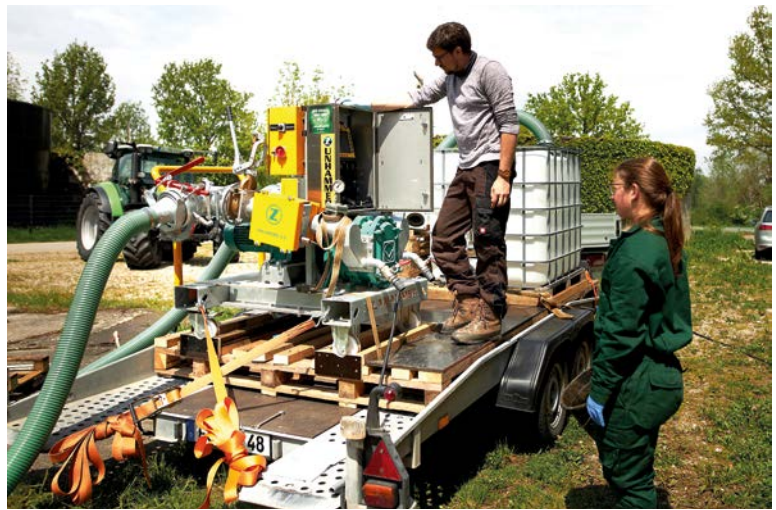
Bild 3: Messanhänger mit drei verschiedenen NIRS-Sensoren (Foto: LfL)
