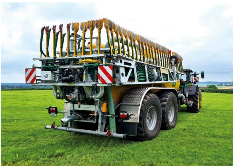
Bild 4: Güllefass mit moderner Ausbringtechnik und NIRS-Sensor (Foto: LfL)
