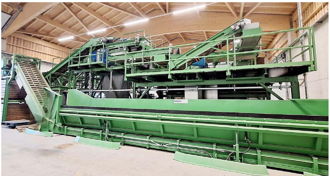
Bild 2: Kartoffel- und Zwiebelsortiermaschine (Foto: Rebecca Brandmann)
