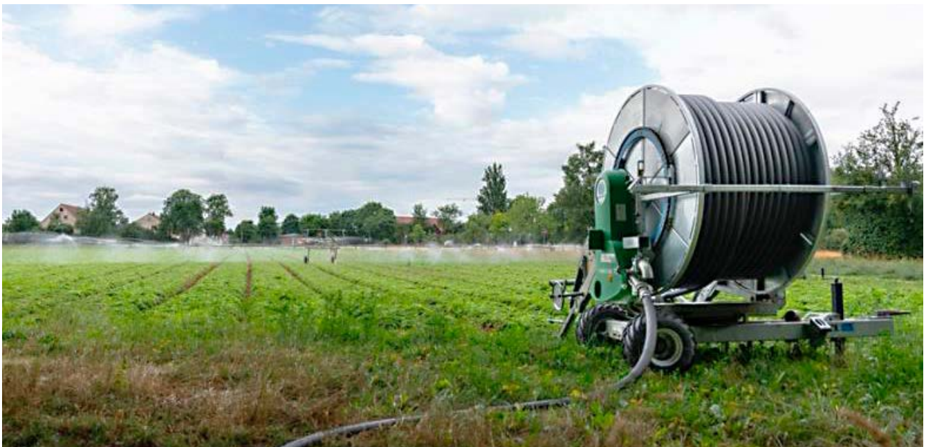
▭ Bild: Das Foto zeigt eine Beregnungsmaschine mit Düsenwagen. Die Technik gewährleistet eine gleichmäßige Querverteilung. Die Verluste durch Abdrift bei Wind sind vergleichsweise gering. (Foto: ALB)
